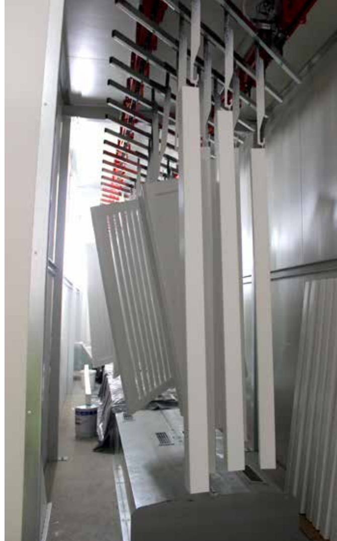
Les produits peints transitent par une chambre de séchage.
