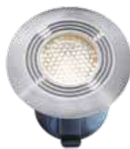
Onyx 30 R1 [150D] Inox 316 LED 0,5W 2.700K - 4lm 41 x 45 mm (HxØ) Manchon dans le sol: 30mm
