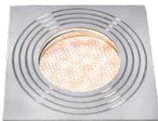
Onyx 60 R4 [154D] Inox 316 LED 1W 2.700K - 23lm 42 x 75 x 75 mm (HXLXP) Manchon dans le sol: 60mm
