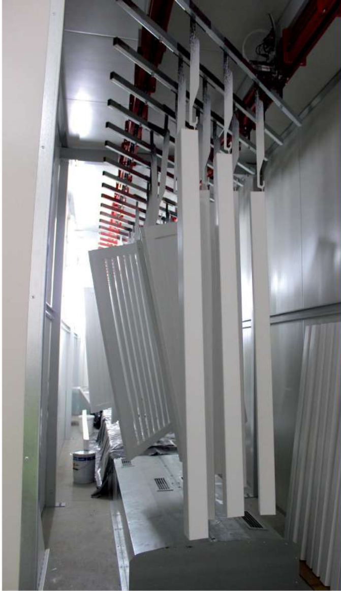
Les produits peints transitent par une chambre de séchage.
