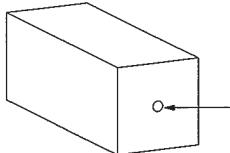
Percer les pieds avec une mèche diamètre 11 mm
