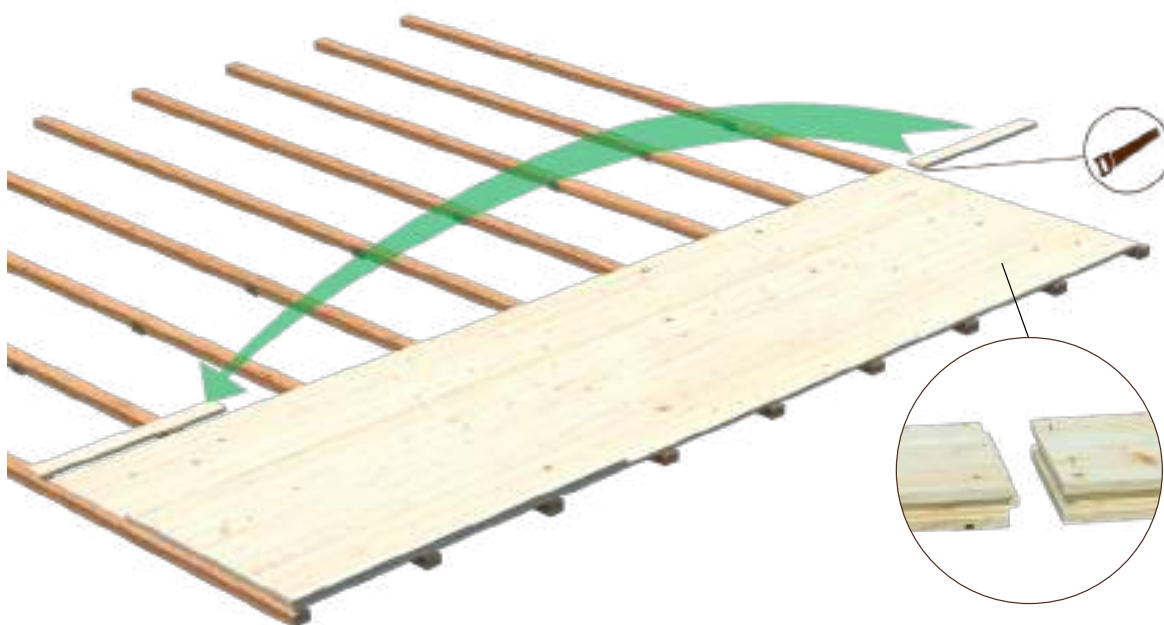
Tenons aux extrémités de lames de plancher
