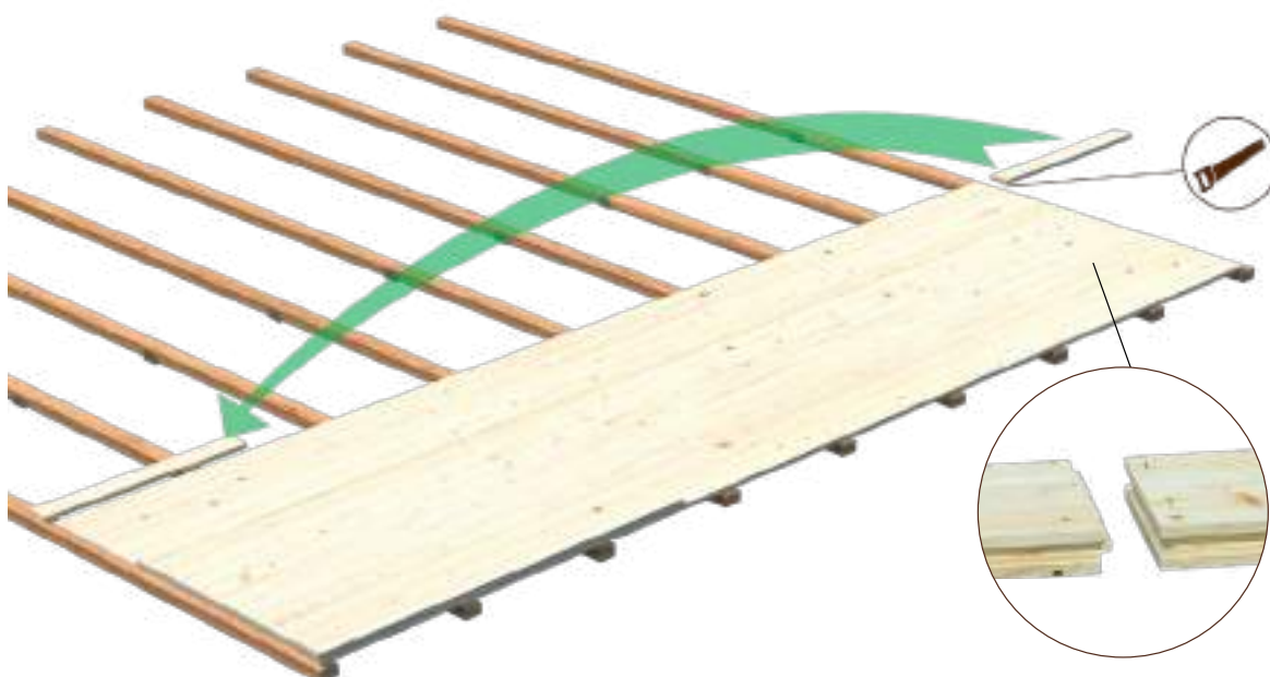
Tenons aux extrémités de lames de plancher
