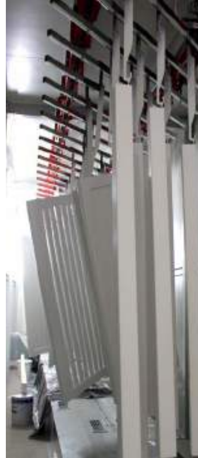
Les produits peints transitent par une chambre de séchage.
