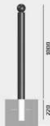
PO 76 B TÊTE BOULE - TUBE Ø 76 ACIER PEINT HS 1000
