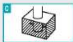
A sceller Fixation dans le sol par scellement dans le béton.
