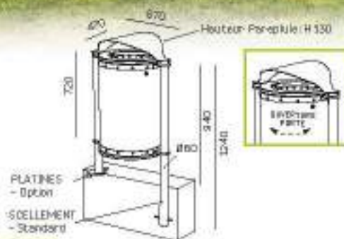
CB 62PP - 80 LITRES POTEAUX Ø 60 - HABILLAGE LAMES DE COMPACT AVEC PORTE SAC - PARE-PLUIE INCLUS
