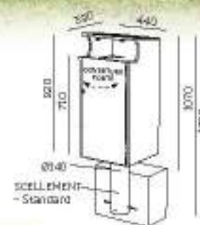
CB 16 - 80 LITRES POTEAUX Ø 140 - HABILLAGE COMPACT EFFET LAMES AVEC PORTE SAC - CONTENANT GALVA EN OPTION
