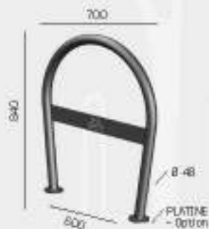
AV 20 P 20 PL PARC À CYCLES - TUBE Ø48 Avec option : plaque métal découpe LASER (P+VELO)
